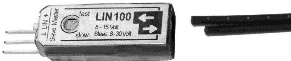
Bild 3: Verbindung LIN 100 mit dem Lichtwellenleiter
