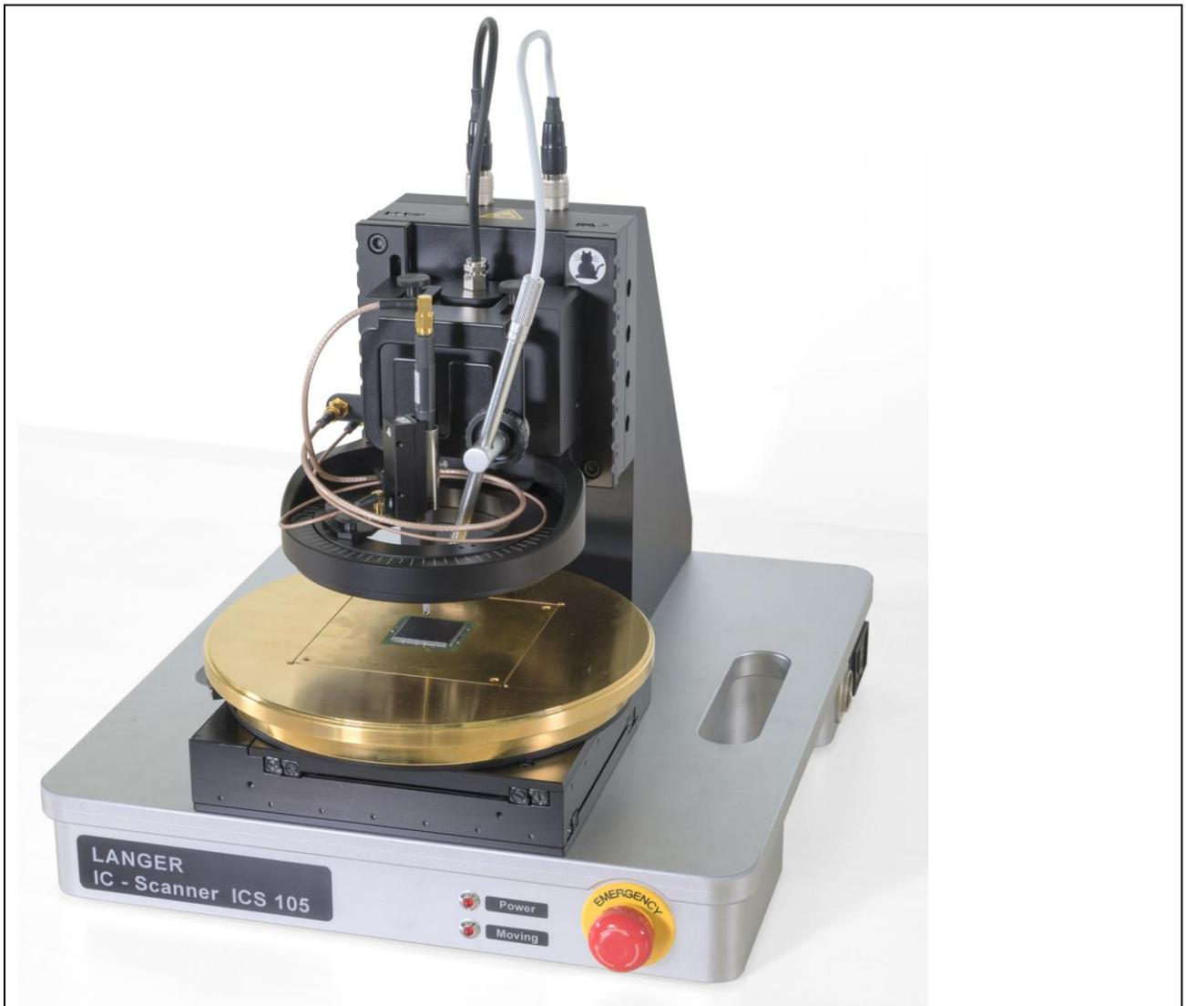
Bild 3: Anwendung der EFT/Burst Feldquelle BS 06DU-s in Verbindung mit den Komponenten des IC-Testsystems IC-Scanner ICS 105 und der IC-Testumgebung ICE1.
