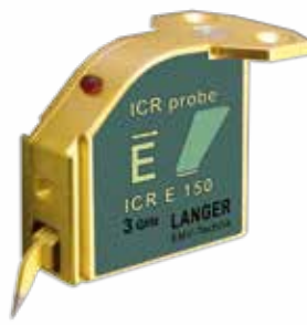
ICR E horizontal 7 MHz - 3 GHz
