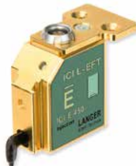
ICI E450 Pulse Electric Field Source
