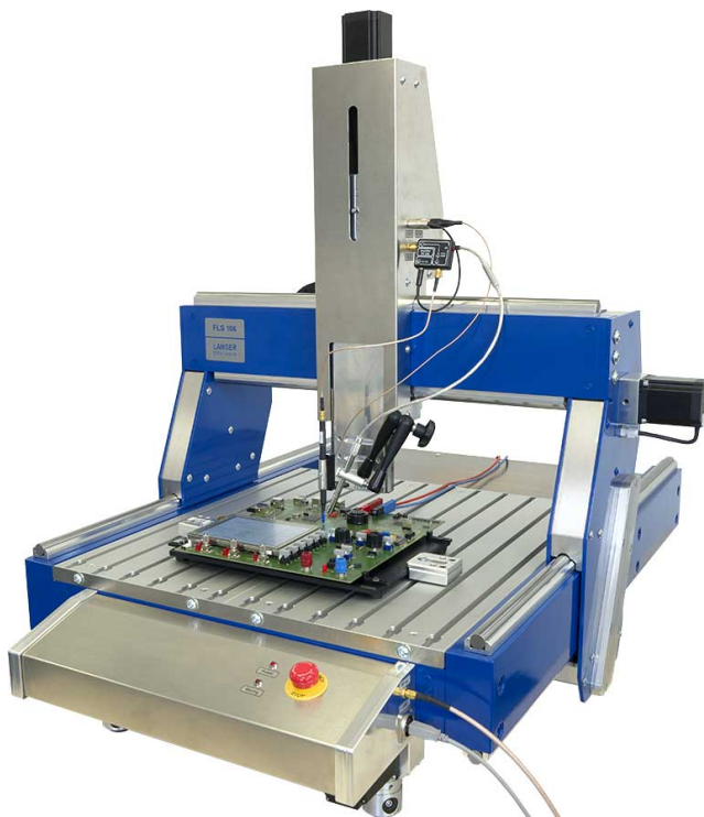
FLS 106 in Anwendung mit Board, Nahfeldsonde und Mikroskopkamera
