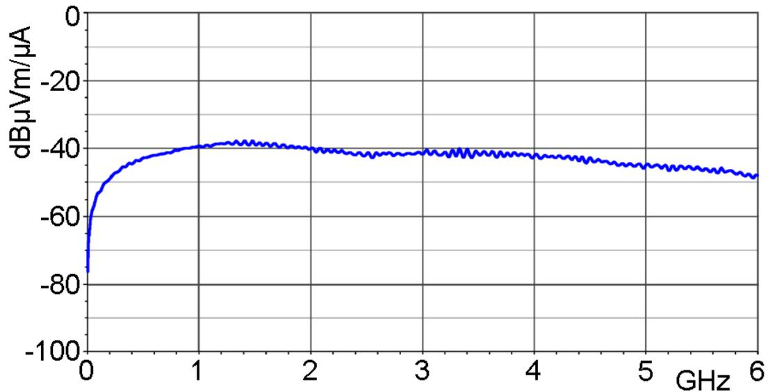
Korrekturkurve H-Feld [dB $\mu$ A/m] / [dB $\mu$ V]
