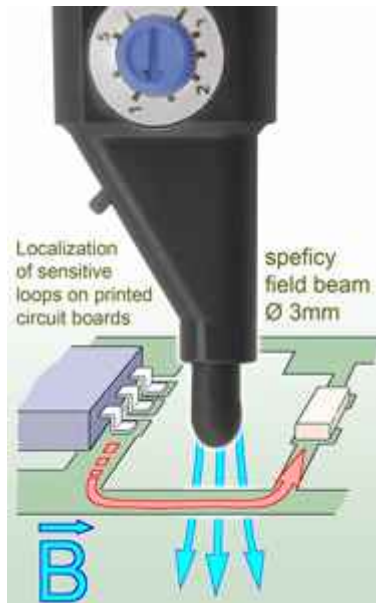
Design of P11 mini burst field generator
