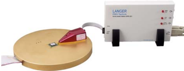
Abbildung 3: Burstmessplatz mit Testbord, Testchip Probe 201 und Spannungsversorgung BPS
